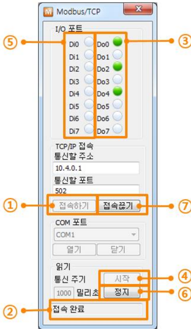
그림 7-3 Modbus/TCP 접속 및 통신 테스트
